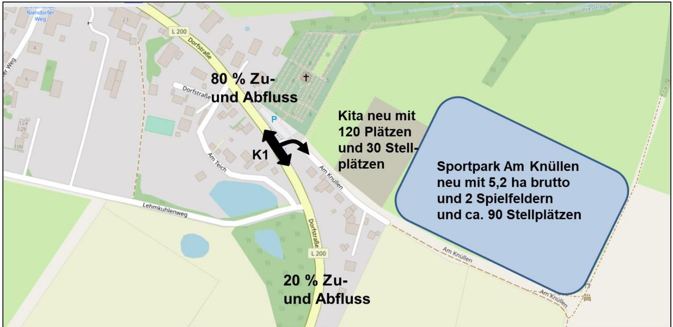
Abbildung 7: Verkehrsverteilung der Kita und Sportpark – Zu- und Abfluss über Erschließungs-Knotenpunkt K1 in Prozenten
