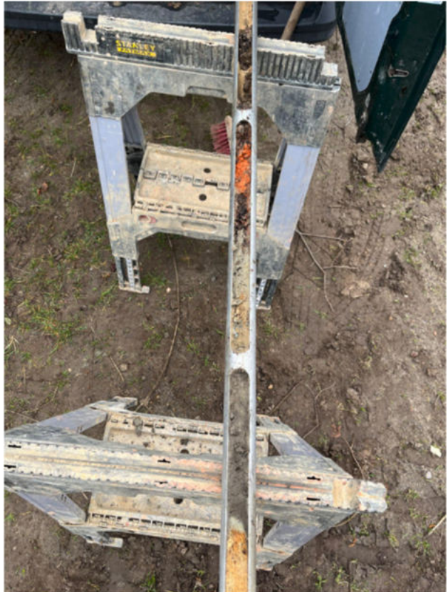
Abb. 5: Bohrsonde SG 9 mit Bauschutt
